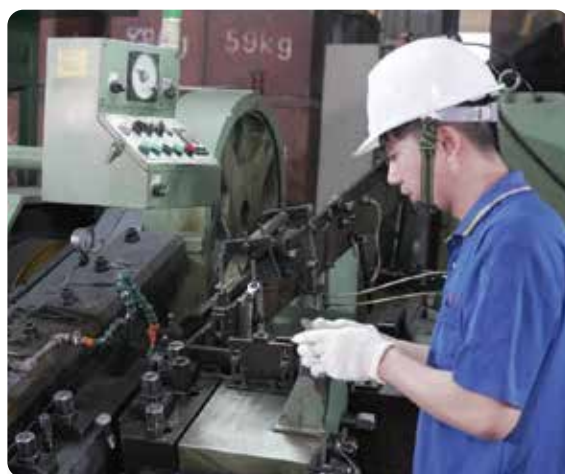
1 福光企業員工進行輻牙尺寸檢驗，以確保產品品質並降低不良率。
