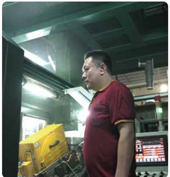
1 舜倡發企業於工廠製程設備裝設感應器，如監測到不良產品產生可立即停機，避免生產過多不良品。
