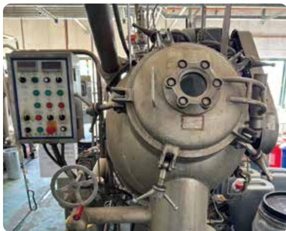
1 榮洲紡織購置的低浴比染色機，屬高階智慧化染整設備，在減少溫室氣體排放的同時，也能降低生產成本，達到環保、產業的雙贏效益。
