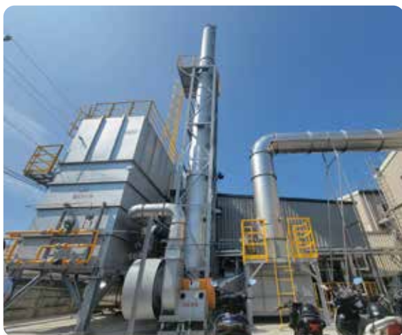
1 嘉成工業的RTO爐及蓄熱燃燒設備，透過將煙囪廢熱回收有效減少天然氣使用、減碳排，達到環保、能源、產業的三贏。
