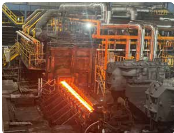
① 東和鋼鐵改善並整合鋼筋加熱爐系統，導入自動控制技術，提升設備操作效率與溫度控制穩定性，進一步達到減碳效能。
