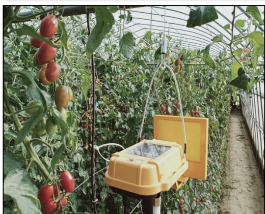
蟲害辨識系統場域架設應用 實例(番茄栽種網室、茶園)
